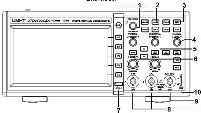
Рисунок 1-2. Передняя панель осциллографа с 7-дюймовым дисплеем
