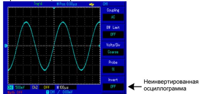
Рисунок 2-8 Настройка вертикальной инверсии (не инвертированная осциллограмма)
