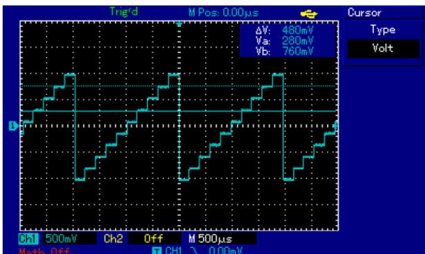
Рисунок 3-6. Курсорное измерение разности потенциалов в сигнале
