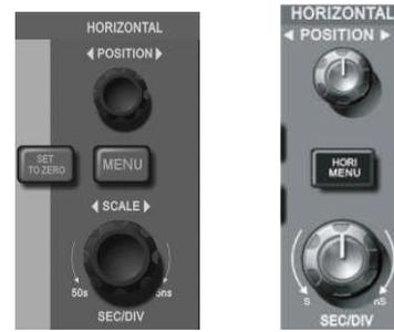
Рисунок 2-11. Интерфейс системы горизонтальной развертки
