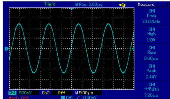
Рисунок 3-1. Автоматические измерения
