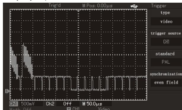
Рисунок 2-16. Запуск по синхроимпульсу кадра видеосигнала
