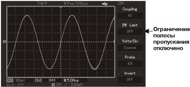
Рисунок 2-4. Вид дисплея без ограничения полной полосы пропускания.
