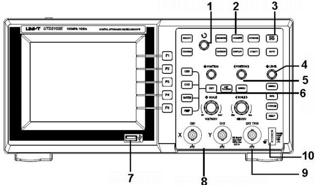
Рисунок 1-1. Передняя панель осциллографа с 5,7-дюймовым дисплеем
