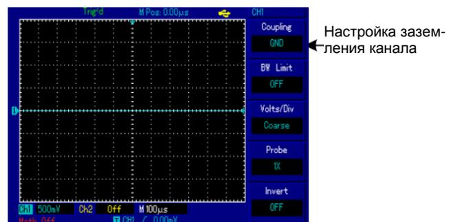
Рисунок 2-3. Отсекаются и переменная, и постоянная составляющие сигнала.
