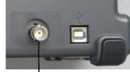
Выход сигнала функции PASS/FAIL на задней панели осциллографа
