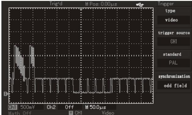
Рисунок 3-8. Запуск по синхроимпульсу кадра видеосигнала
