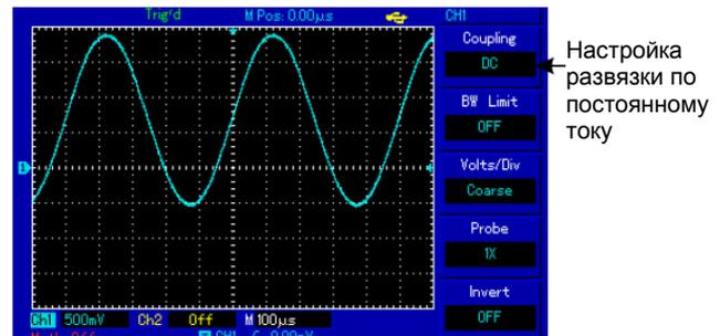
Рисунок 2-2. Одновременное отображение переменной и постоянной составляющих сигнала.
