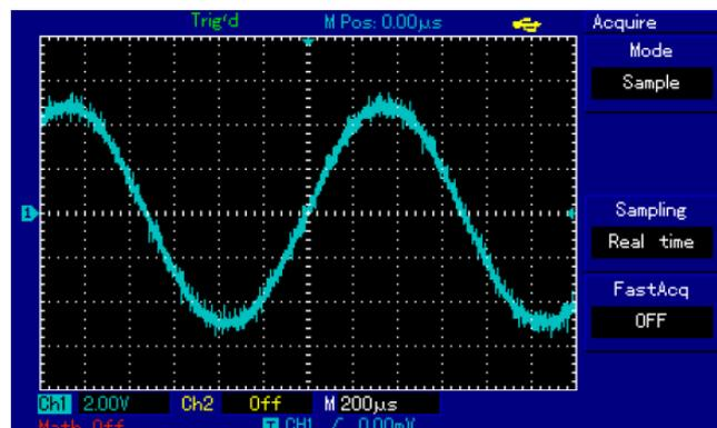
Рисунок 2-20. Осциллограмма в режиме выборки без усреднения
