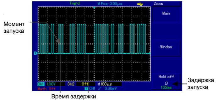
Рисунок 2-18. Использование функции задержки для синхронизации сложной осциллограммы
