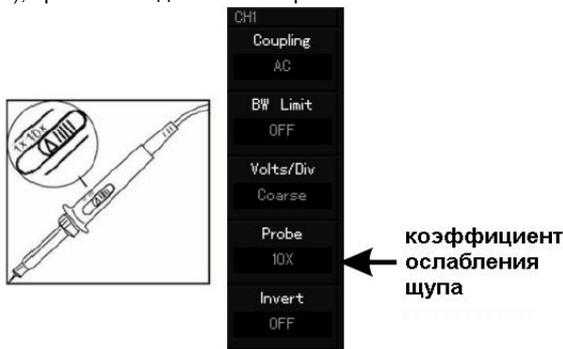
Рисунок 1-6. Установка коэффициента ослабления в настройках осциллографа
