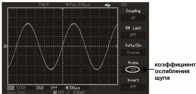
Рисунок 2-6. Установка коэффициента ослабления щупа в меню канала.
