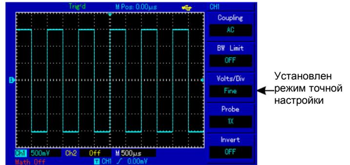
Рисунок 2-7. Грубая и точная настройка коэффициента вертикальной развертки
